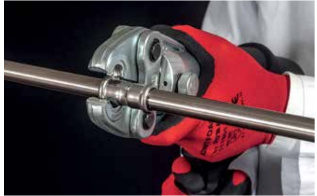
Assemblaggio attraverso pressatura / Making the press connection
